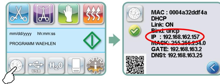
3. Saisissez l'adresse IP affichée sur l'écran tactile dans le navigateur d'un appareil compatible Web afin d'accéder au portail Web de votre appareil. L'adresse IP a été attribuée lorsque la X rouge n'est plus visible au-dessus du symbole du réseau. Si le symbole du réseau est actif (par exemple, lors de l'envoi d'un e-mail), il devient vert.
