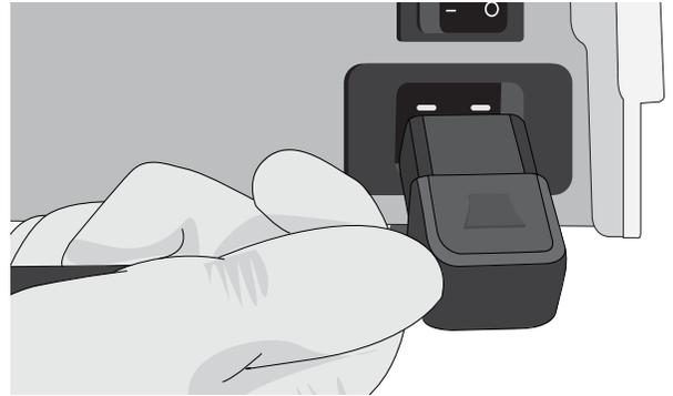
2. Verbinden Sie es direkt mit der Stromversorgung. Verwenden Sie kein Verlängerungskabel.
