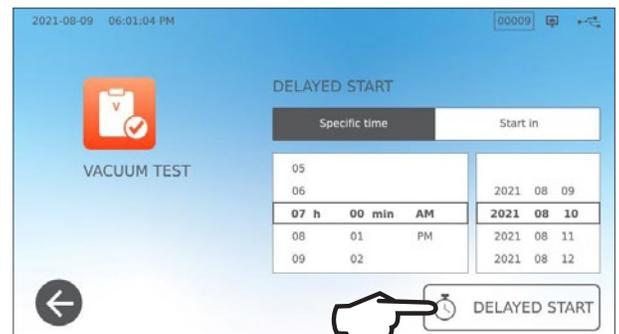
5. Drücken Sie auf das Symbol **ZURÜCK**, um den Countdown zurückzusetzen. Der LCD-Bildschirm bleibt bis zum Beginn des Zyklus im Modus „Verzögerter Start“.
