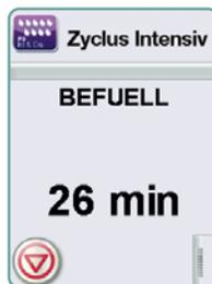
Der Zyklus beginnt mit einem Abpumpen des Gerätes. Der Balken auf dem Bildschirm zeigt den Fortschritt an. Unter dem Balken wird der Schritt im Ablauf angezeigt (z.B. Füllen, Spülen). Stets wird die voraussichtliche Restdauer (in Minuten) angezeigt. Beachten Sie bitte, dass sich die Dauer je nach prognostiziertem Zyklusende verkürzen oder verlängern kann.
