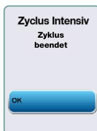
Nach Abschluss des Zyklus wird der Programmname und „Zyklus beendet“ angezeigt und das Gerät piept dreimal. Zum Öffnen der Tür drücken Sie auf „OK“. Entnehmen Sie die Instrumente mit Handschuhen. Seien Sie vorsichtig, da die Instrumente, Einschübe, Körbe und Kassetten heiß sein können. Kontrollieren Sie die Instrumente auf mögliche Rückstände, bevor Sie diese verpacken / sterilisieren.
