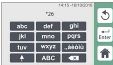
MANUAL ENTRY permette di modificare manualmente l'SSID e la PASSWORD della rete Wi-Fi, e di confermare premendo ENTER.
