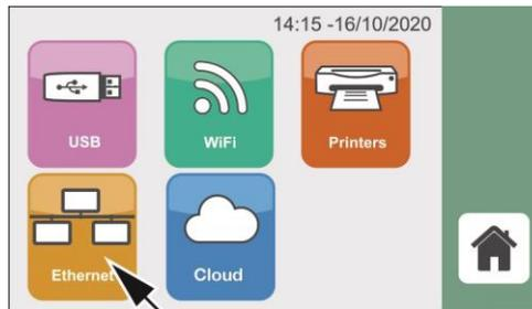
È possibile impostare il DHCP in Automatico o Manuale. In modalità DHCP Automatico, i parametri di configurazione di rete sono assegnati automaticamente. In modalità DHCP Manuale, i parametri di configurazione di rete devono essere impostati manualmente.
