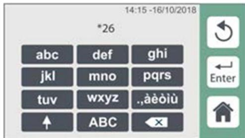
MANUAL ENTRY permet de modifier manuellement le SSID et le MOT DE PASSE du réseau Wi-Fi, et de confirmer en appuyant sur ENTER. Appuyer sur la touche SSID ou PSW pour afficher le clavier pour la modification.
