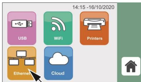
Il est possible de programmer le DHCP comme Automatique ou Manuel. En mode DHCP Automatique, les paramètres de configuration du réseau sont automatiquement attribués. En mode DHCP Manuel, les paramètres de configuration du réseau doivent être configurés manuellement.
