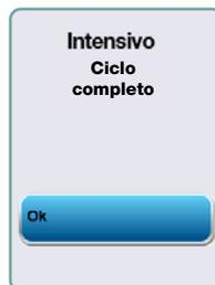
Quando il ciclo è terminato, vengono visualizzati il nome del programma e l'indicazione "Ciclo completo" e l'unità emette tre bip. Premere "OK" per aprire la porta. Utilizzare i guanti per scaricare gli strumenti. Al termine di tutti i cicli osservare cautela poiché gli strumenti, il carrello, i cestelli e le cassette possono essere roventi. Ispezionare gli strumenti per verificare che non presentino ancora impurità prima di imbustarli / sterilizzarli.
