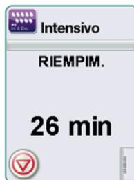
Il ciclo comincia effettuando lo scarico dell'unità. La barra sullo schermo indica lo stato di progressione del ciclo. La fase del ciclo è indicata sotto alla barra (es. Riempimento, Risciacquo). Viene sempre visualizzato il tempo rimanente stimato (in minuti). Si noti che il tempo aumenta o diminuisce in funzione del previsto completamente del ciclo.
