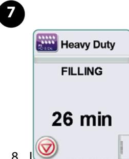
Цикл запускает дренаж автомата. Полоса на экране указывает на продвижение цикла. Этап цикла указан под полосой (например, Заполнение, Ополаскивание). Также всегда отображается приблизительный остаток времени цикла (в минутах). Обратите внимание, что период времени будет увеличиваться или уменьшаться в зависимости от намеченного времени завершения цикла.
