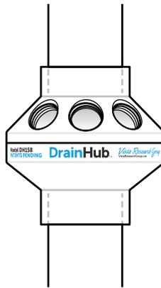
Insertion du conduit principal de 1½ po à l'intérieur des orifices d'entrée et de sortie
